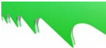
Többélű vágóél SzétDaraboltabb forgács
